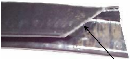
Trim lower edge on an angle
